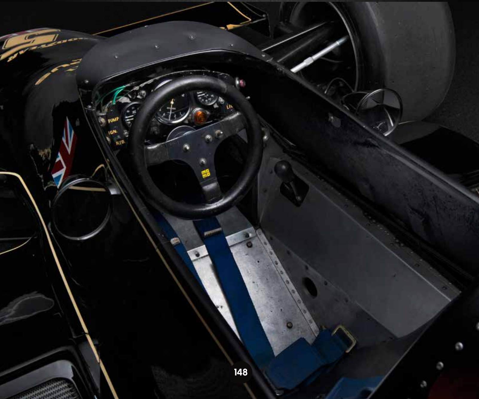
Dotée d'une coque très étroite (ci-dessus), la Lotus 79 cherchait à maximiser le passage du flux d'air dans les pontons. La vue arrière (page de droite) montre bien que le tunnel passant dans chaque ponton était aussi dégagé que possible.
