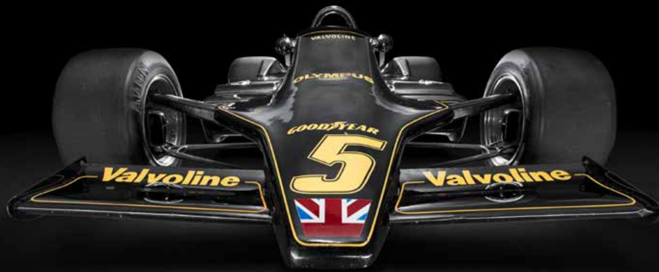
Dotée d'une coque très étroite (ci-dessus), la Lotus 79 cherchait à maximiser le passage du flux d'air dans les pontons. La vue arrière (page de droite) montre bien que le tunnel passant dans chaque ponton était aussi dégagé que possible.
