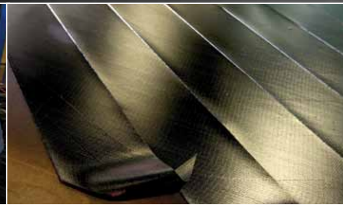
Haute-couture. De nombreuses nappes textiles de natures diverses sont préparées. Le coton de jadis a cédé place à des matériaux plus modernes : kevlar, fibres de carbone, fibres hybrides, etc.
