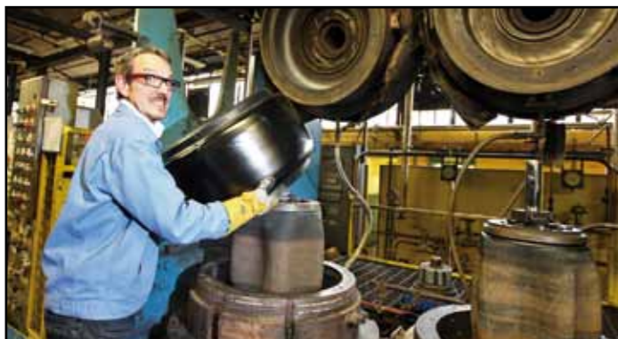
Au four ! Voici l'étape assurément la plus spectaculaire : j'installe la carcasse dans un moule qui va la cuire autour d'un tambour. Une fois rempli de liquide sous pression, ce dernier va donner sa forme au pneu et procéder à la phase de vulcanisation.
