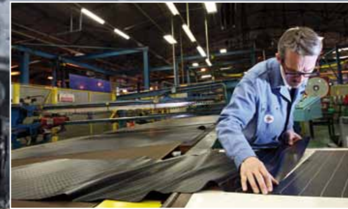
Assemblage. Les différentes nappes textiles sont assemblées selon des angles précis qui participeront à la structure radiale du pneu. Cette dernière offre une excellente rigidité à la torsion latérale.
