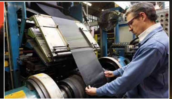
Il faut se décarcasser ! Etape cruciale : la confection de la carcasse. Elle associe les tringles métalliques, une couche d'étanchéité, deux couches de « pli carcasse » jointe de façon à assurer une adhésion ainsi qu'un renfort. Sous une pression d'air, la gomme se rabat autour de la tringle.
