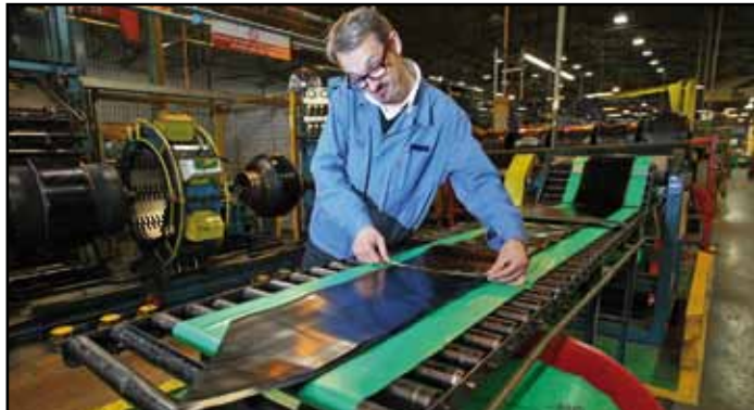
Contrôle. Pas question d'assembler un pneu sans s'assurer une nouvelle fois que la bande de roulement présente bien la largeur souhaitée. Pour faire un pneu arrière de proto, comptez 37 cm pour une LM P1 et seulement 31 cm pour une LM P2.
