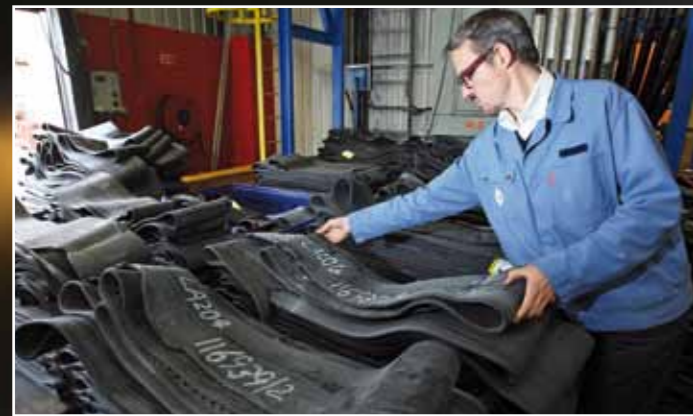
A plat. Les « mélanges » sont stockés sous forme de larges rubans repliés, ce qui permet d'éviter un effet de cuisson. Certains mélanges seront employés pour faire des bandes de roulement, d'autres pour des flancs, etc. A ce stade, il ne gardent leurs caractéristiques que quelques jours.
