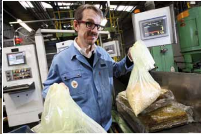
Au broyeur ! Pour obtenir un « mélange » de gomme, on place les composants (ici des pains de caoutchouc et des sacs d'additifs) dans un immense broyeur, comme le ferait un cuisinier équipé d'un robot ménager.
