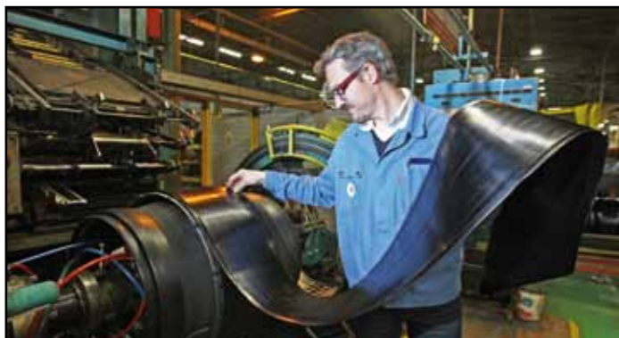
Au millimètre ! Il est temps de rajouter la bande de roulement à la carcasse ainsi que la frette et la nappe sommet. Par rapport aux pneus de série, un grand soin est apporté à cette étape très délicate sur les pneus de compétition. Des repères laser guident l'opération.
