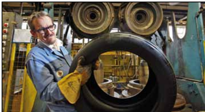
Chaud devant ! Ça y est, c'est prêt ! Le pneu est quasiment terminé. Après 10 à 40 minutes de cuisson à une température dépassant allègrement les 100°, le pneu a enfin sa forme définitive. Attention de ne pas se brûler !
