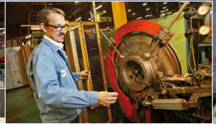
Du costaud ! La tringle qui viendra appliquer le pneu contre la jante est composée d'un gros fil d'acier enduit de gomme. Elle reprend le diamètre intérieur du pneu, à savoir 18" sur les prototypes LM P1 et LM P2.
