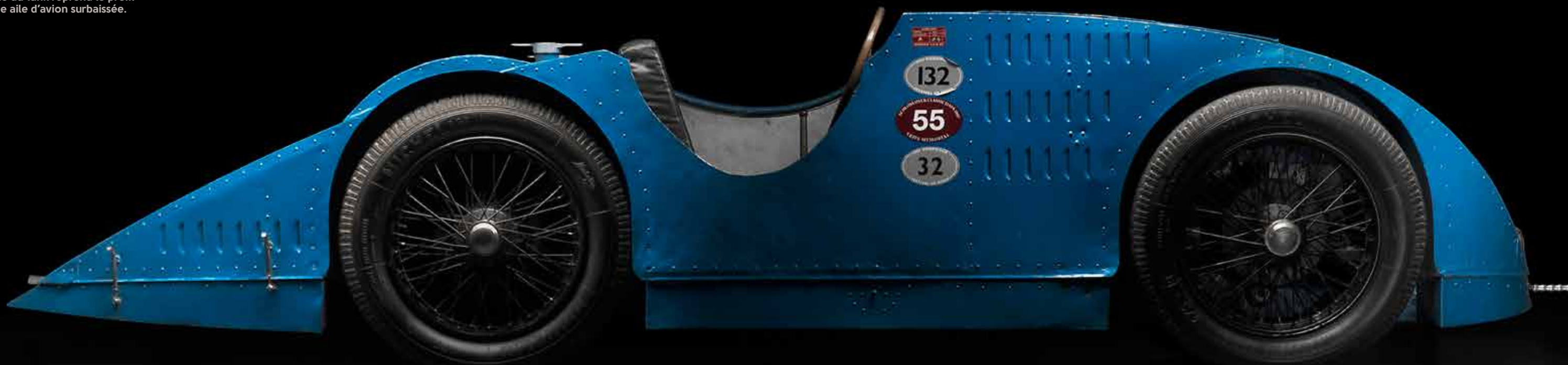
L'imposant 8 cylindres développant une centaine de chevaux empiète sur l'habitacle (ci-dessus). La vue ci-contre, quant à elle, confirme que la forme du Tank reprend le profil parfait d'une aile d'avion surbaissée.
