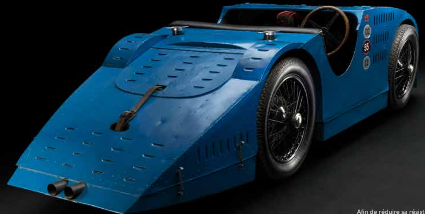
Afin de réduire sa résistance à l'air, le Tank affiche des dimensions très réduites : une voie de 1 m et un empattement de 2 m.
