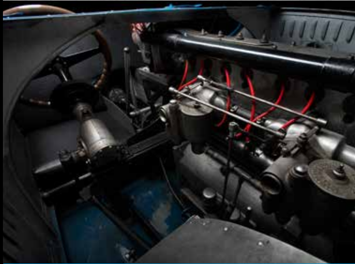
L'imposant 8 cylindres développant une centaine de chevaux empiète sur l'habitacle (ci-dessus). La vue ci-contre, quant à elle, confirme que la forme du Tank reprend le profil parfait d'une aile d'avion surbaissée.
