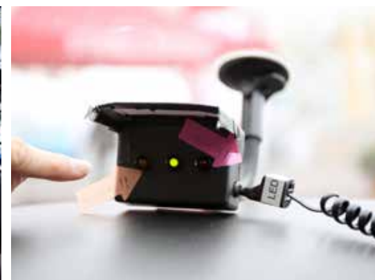
Placées derrière le volant, ces diodes indiquent au pilote s'il doit accélérer ou ralentir.
